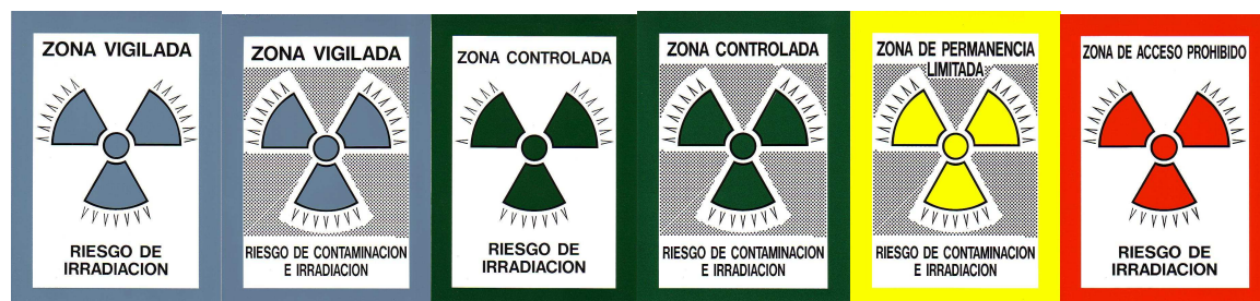
Fig. 19.2.: Diferentes carteles de señalización de zonas de trabajo según el nivel y el tipo de riesgo radiológico. Obsérvese el dibujo de puntas radiales para indicar el riesgo de irradiación externa, y/o el de campo punteado para indicar el riesgo de contaminación.
