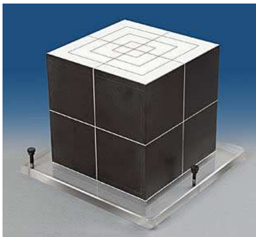
Fig. 17.12.: Maniquí de verificación y alineación geométrica y mecánica.
