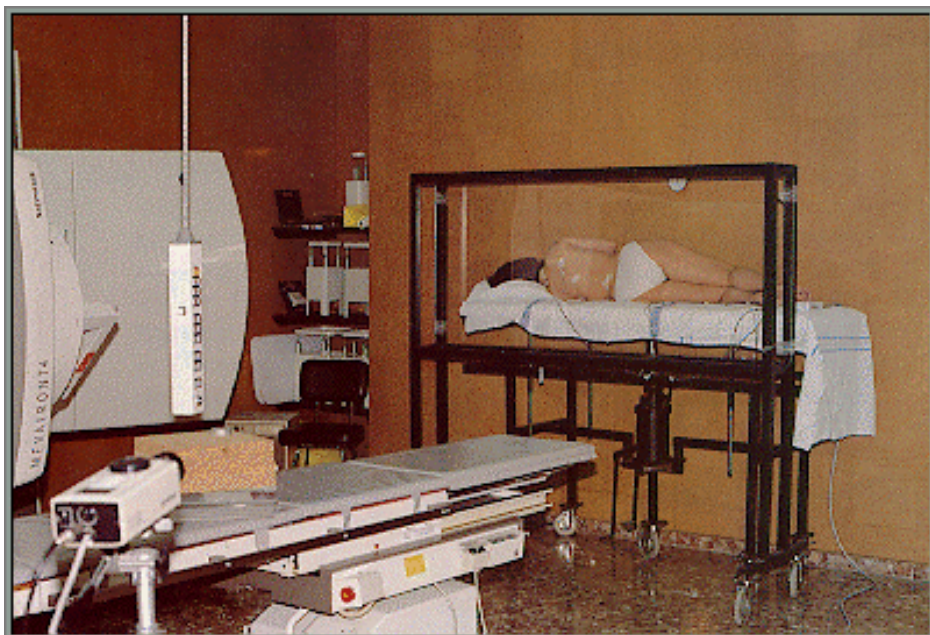
Fig. 18.9.: Colocación del paciente para una sesión de Irradiación Corporal Total. Nótese la pantalla de metacrilato enfrente del paciente para lograr el equilibrio electrónico en piel.
