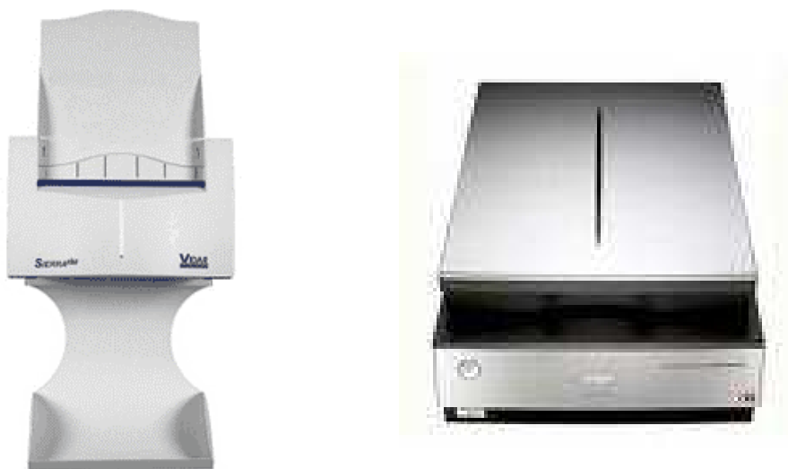
Fig. 8.19.: Diferentes modelos de escáneres para el análisis de la densidad óptica de película radiográfica, utilizada como dosímetro en el control de haces de radioterapia externa.
