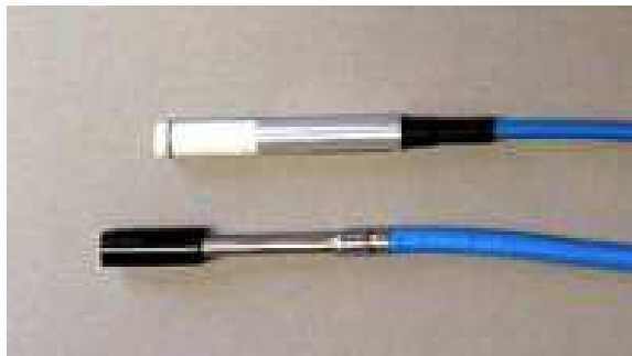
Fig. 8.12.: Detectores de semiconductor utilizados para dosimetría relativa en Radioterapia.
