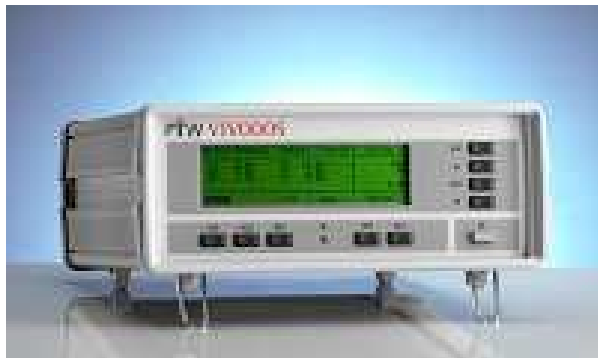
Fig. 8.5.: Electrómetro utilizado para medir la corriente proveniente de una cámara de ionización.
