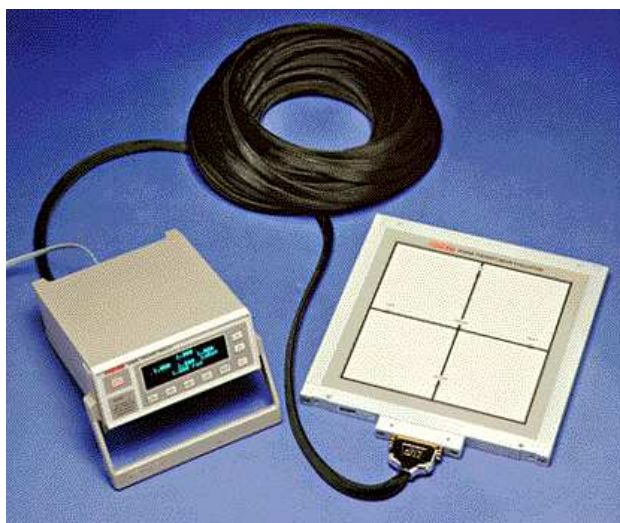
Fig. 12.9.: Aparato para el control diario de la uniformidad de haces en los aceleradores.
