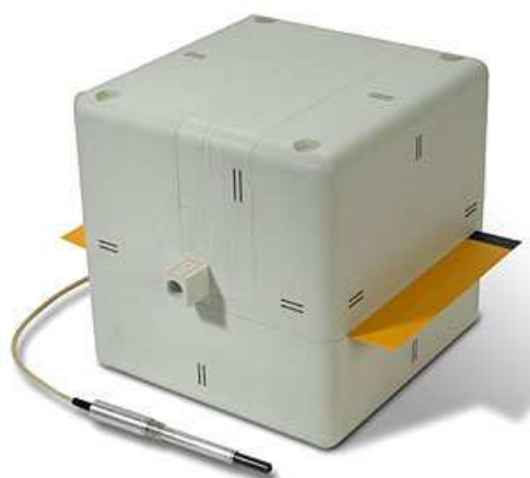
Fig. 17.11.: Maniquí no antropomórfico con posibilidad de alojamiento para cámara de ionización y para película radiográfica, apropiado para control de calidad en la técnica IMRT.
