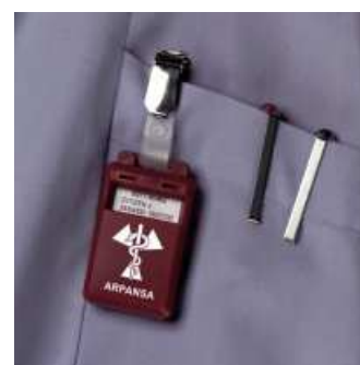
Fig. 8.15.: Dosímetro TLD envuelto en carcasa de plástico para dosimetría personal de cuerpo entero.
