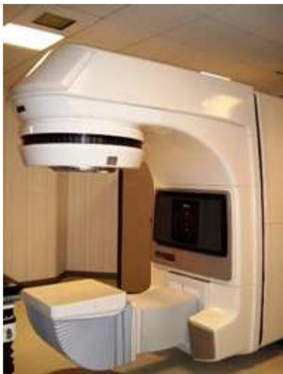
Fig. 3.1. Acelerador con sistema de visión portal basado en pantalla fluorescente y cámara de vídeo .
