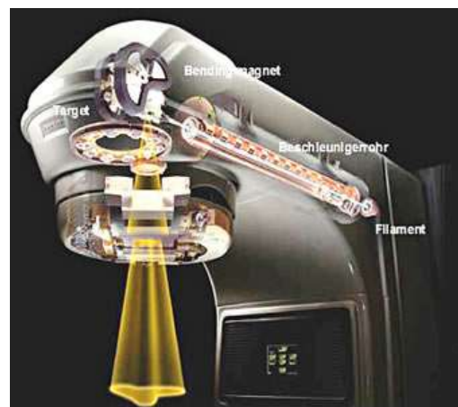
Fig. 10.18.: Detalle del cabezal de un acelerador lineal modelo "Clinac 2100", mostrando la formación de un haz clínico de fotones.
