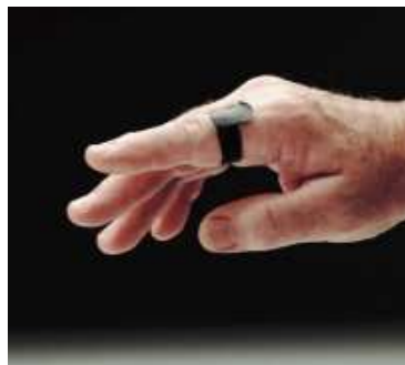
Fig. 8.14.: Anillo de plástico conteniendo un dosímetro TLD para dosimetría personal en los dedos de las manos.
