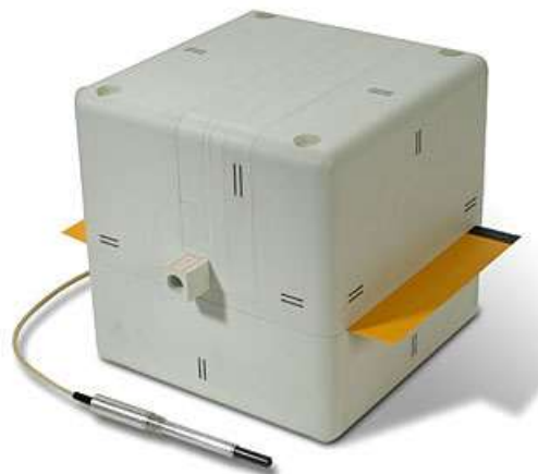
Fig. 17.11.: Maniquí no antropomórfico con posibilidad de alojamiento para cámara de ionización y para película radiográfica, apropiado para control de calidad en las técnicas IMRT / VMAT.
