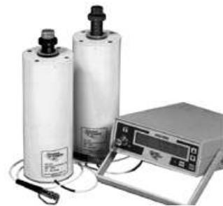
Fig. 17.2.: Cámaras "pozo" de referencia para la determinación de la TKRA de las fuentes de Braquiterapia.
