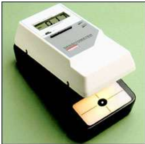
Fig. 8.16.: Densitómetro para la medida punto a punto de la densidad óptica en una película radiográfica.
