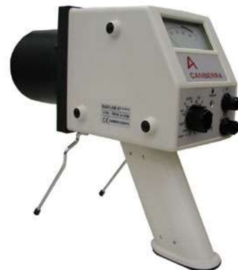
Fig. 8.8.: Cámara de ionización cilíndrica tipo "Babyline", de gran volumen, especial para medida de bajas dosis en Protección Radiológica.
