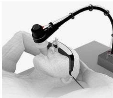
Fig. 21.6.: Sistema utilizado para el control de la respiración del paciente en técnicas de "gating". El flujo de aire inhalado / exhalado por el paciente es monitoreado en todo momento, lo que permite establecer la fase concreta del ciclo respiratorio en la cual se está tomando en ese instante la imagen TC. El mismo sistema se utiliza después para el tratamiento, permitiendo solo la irradiación cuando la respiración se encuentre en una fase determinada, en la cual el volumen tumoral se ubica en la posición de planificación
