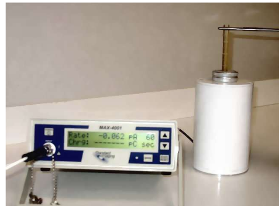
Fig. 8.6.: Electrómetro y cámara de ionización cilíndrica tipo "pozo" para la medida de la tasa de kerma de fuentes de braquiterapia.
