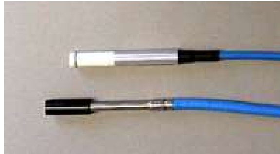
Fig. 8.12.: Detectores de semiconductor utilizados para dosimetría relativa en Radioterapia.
