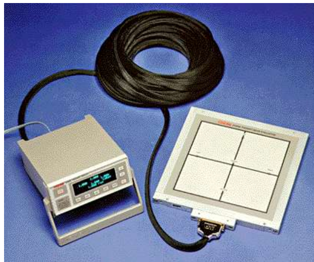
Fig. 12.9.: Equipo dosimétrico para el control diario de la uniformidad de haces en los aceleradores.
