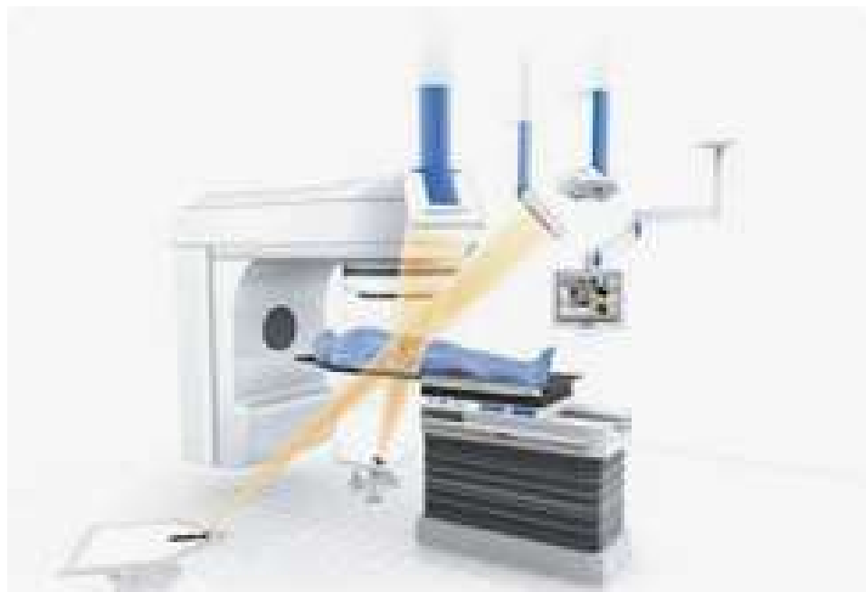
Fig. 18.14.: Sistema ExacTrac instalado en el búnker de un acelerador lineal. Los dos tubos de RX se encuentran en el suelo, y emiten haces RX en oblicuo que, tras atravesar el paciente, son captados por paneles planos situados en el techo. Las imágenes planares obtenidas son comparadas con las imágenes planares de referencia que el algoritmo reconstruye a partir de las imágenes TC de planificación.
