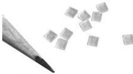
Fig. 17.7.: "Chips" de material TLD, utilizados para control de calidad y dosimetría " in vivo ". Nótese su pequeño tamaño comparado con el de la punta de un lápiz, lo que les hace adecuados para zonas de moderado gradiente de dosis.
