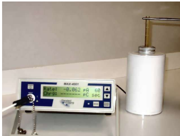
Fig. 11.1.: Verificación de la TKRA de un tren de fuentes de I-125 para su uso en braquiterapia prostática.
