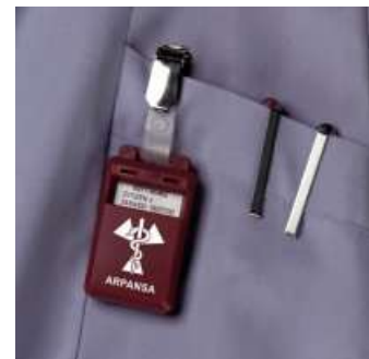
Fig. 8.15.: Dosímetro TLD envuelto en carcasa de plástico para dosimetría personal de cuerpo entero.
