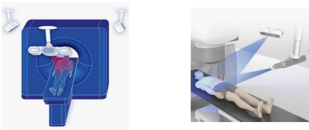
Fig. 18.18: Sistema de SGRT, acoplado tanto a un TC de simulación como a un acelerador lineal. Se aprecian, ancladas en el techo, 3 cámaras que monitorean en todo momento la superficie del paciente, generando una imagen 3D de la misma. La imagen tomada en el TC (o la tomada en la sesión inicial de tratamiento) se suele tomar de referencia, de modo que en el posicionado en el acelerador y durante el tratamiento se verifica en tiempo real y en todo momento que la imagen SGRT coincida con dicha referencia.
