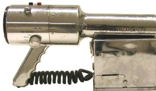
Fig. 8.11.: Detector de centelleo usado como monitor de radiación ambiental.
