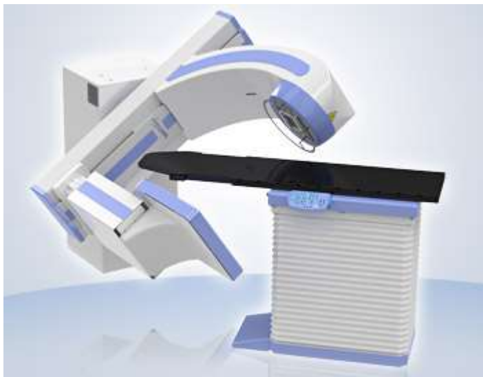
Fig. 19.8.: Simulador de última generación, mostrando desplegado el "flat panel" de silicio amorfo.
