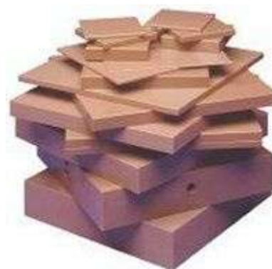
Fig. 17.9.: Láminas de “agua sólida” de distintos tamaños y espesores. Nótese como alguna de ellas dispone de alojamiento para cámara de ionización cilíndrica.
