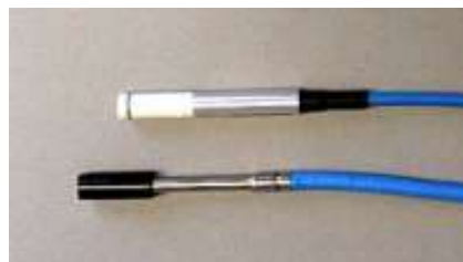
Fig. 17.4.: Diodos de semiconductor, apropiados para dosimetría física en haces de electrones y fotones.
