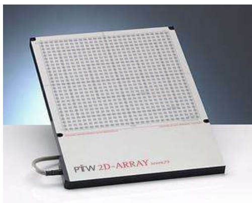
Fig. 17.5.: Array 2D de 27x27 cámaras de ionización para medida rápida de distribuciones de dosis en un plano.
